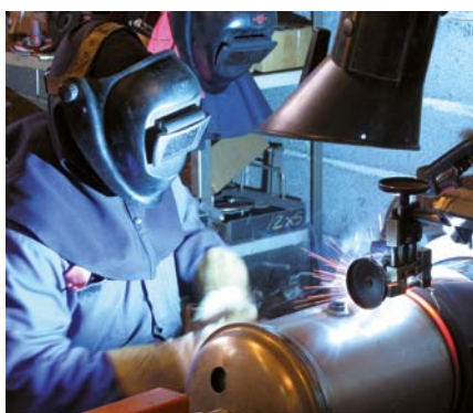
Kuva 21. Matalapaineiset kohdepoistojärjestelmät ovat yleisin ratkaisu hitsaussavujen poistoon teollisuudessa.
